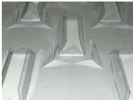
c) Flow Up Vortex generator
