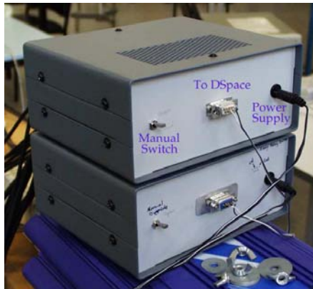
(d) Switch box - Back view
